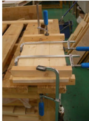
接着する面に木工用接着剤を塗り、右の写真のように、板厚方向を当て木で押さえておいて、側面からクランプで締め付けて、乾燥させます。
